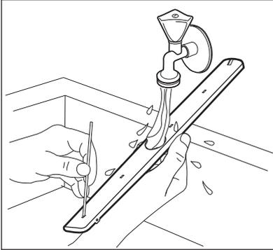
4. Setzen Sie zum wieder Einsetzen des Sprüharms (C) das Montageelement (B) in den Sprüharm ein und drehen Sie ihn im Uhrzeigersinn, um ihn am Überleitungsrohr (A) zu befestigen. Achten Sie darauf, dass das Montageelement einrastet.
