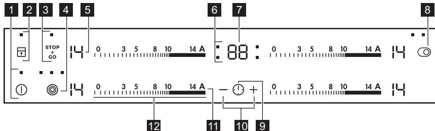
Brug sensorfelterne til at betjene apparatet. Display, kontrollamper og signaler viser de funktioner, der er i brug.
