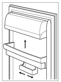
Dieses Modell ist mit einem variablen Lagerfach ausgerüstet, das sich seitlich verschieben lässt.
