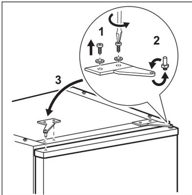
9. Nehmen Sie das Scharnier ab. Stecken Sie es in Pfeilrichtung auf den Stift. Befestigen Sie das Scharnier an der gegenüberliegenden Seite.
