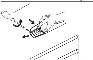
3. Ersetzen Sie die alte Lampe durch eine Lampe mit der gleichen Leistung (die maximal erlaubte Leistung steht auf der Lampenabdeckung), die speziell für Haushaltsgeräte vorgesehen ist.
