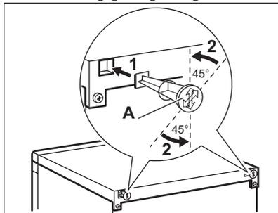
2. Drehen Sie die Distanzstücke um  $45^\circ$  nach links, bis sie einrasten.
