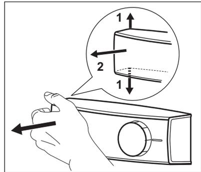
2. Ersetzen Sie die Lampe durch eine Lampe mit denselben Eigenschaften, die speziell für Haushaltsgeräte vorgesehen ist.
