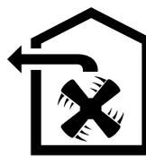
De aangezogen lucht wordt door de vetfilters gereinigd en via een buizensysteem naar de buitenlucht afgevoerd.
