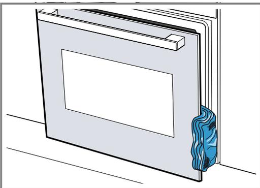
2. An der Gerätetür die Schrauben links und rechts lösen und entfernen.
