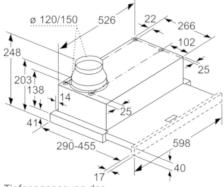
Tiefenanpassung des Filterauszuges bis 29 mm möglich
