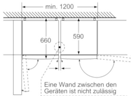
Die beiden dargestellten Geräte sind identisch. (Mit unterschiedlichem Türanschlag)
