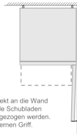
Wird das Gerät direkt an die Wand gestellt, können alle Schubladen vollständig herausgezogen werden.
