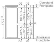
Die angegebenen Möbeltürmaße gelten für eine Türfuge von 4mm. Bei Verwendung einer anderen Fugenbreite (max.14 mm) müssen die Maße angepaßt werden. Bei größeren Maßen (1780 - 1790) muss an der Nischendecke eine Distanzleiste vorgesehen werden.
