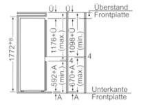
Die angegebenen Möbeltürmaße gelten für eine Türfuge von 4mm. Bei Verwendung einer anderen Fugenbreite (max.14mm) müssen die Maße angepaßt werden.
