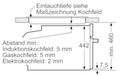
Wird das Kompaktgerät unter einem Kochfeld eingebaut, muss folgende Arbeitsplattenstärke (ggf. inkl. Unterkonstruktion) beachtet werden.
