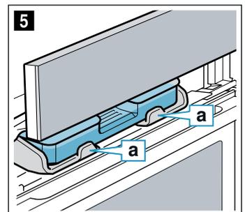
7. Blende langsam nach unten schieben, dann nach hinten drücken, bis sie vollständig geschlossen ist. Der Wassertank ist gefüllt. Sie können Betriebe mit Dampf starten.
