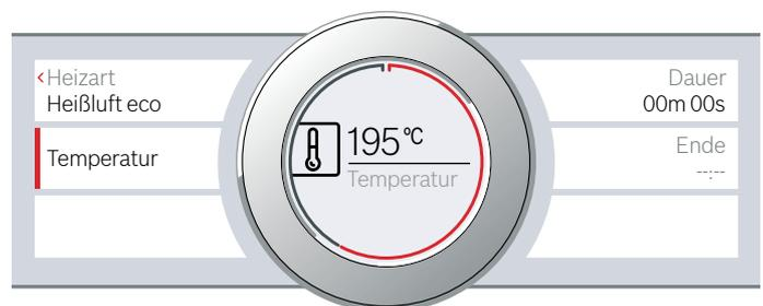
3. Mit Taste start/stop
