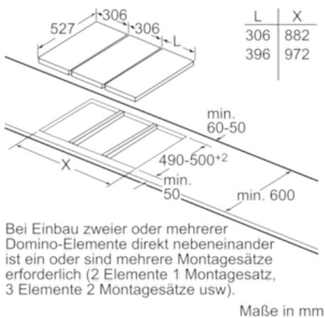
Bei Einbau zweier oder mehrerer Domino-Elemente direkt nebeneinander ist ein oder sind mehrere Montagesätze erforderlich (2 Elemente 1 Montagesatz, 3 Elemente 2 Montagesätze usw.).
