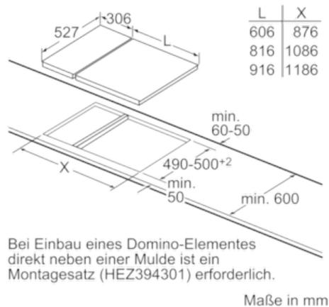
Bei Einbau eines Domino-Elementes direkt neben einer Mulde ist ein Montagesatz (HEZ394301) erforderlich.
