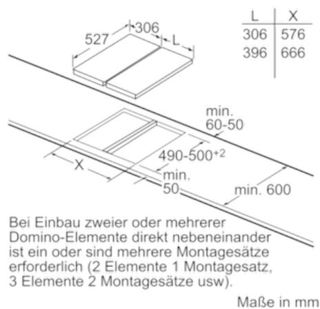
Bei Einbau zweier oder mehrerer Domino-Elemente direkt nebeneinander ist ein oder sind mehrere Montagesätze erforderlich (2 Elemente 1 Montagesatz, 3 Elemente 2 Montagesätze usw.).
