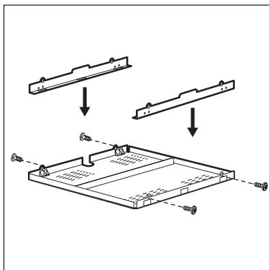
Falls Sie einen Schutzboden (optionales Zubehör) verwenden, ist die Einhaltung des vorderen Belüftungsabstands von 2 mm und die Schutzmatte direkt unter dem Gerät nicht nötig. Der Schutzboden ist möglicherweise in einigen Ländern nicht erhältlich. Wenden Sie sich an Ihren Händler vor Ort.
