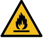
► Dieses Kältegerät enthält das Kältemittel Isobutan (R600a), ein Naturgas mit hoher Umweltverträglichkeit, aber brennbar. Das Kältemittel schädigt nicht die Ozonschicht und erhöht nicht den Treibhauseffekt.
