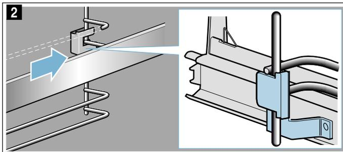
3. "PUSH" drücken und Schiene nach innen schwenken, so dass der Halter sich zwischen den beiden Stäben befindet (Bild 3).
