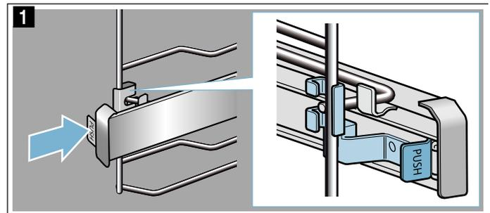
2. "PUSH" gedrückt halten und Schiene nach außen schwenken (Bild **2**).
