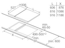
Bei Einbau eines Domino-Elementes direkt neben einer Mulde ist ein Montagesatz (HEZ394301) erforderlich.
