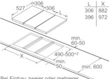
Bei Einbau zweier oder mehrerer Domino-Elemente direkt nebeneinander ist ein oder sind mehrere Montagesätze erforderlich (2 Elemente 1 Montagesatz, 3 Elemente 2 Montagesätze usw).
