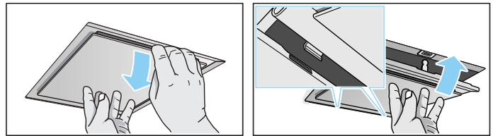
Bei Zusatzfiltern im Innenraum, Verriegelung öffnen und den Metallfettfilter herunterklappen. Dabei mit der anderen Hand unter den Metallfettfilter fassen.
