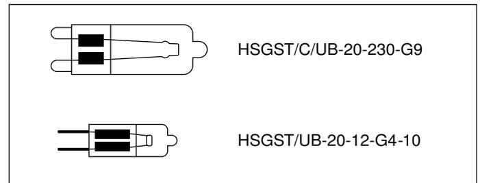
**Hinweis:** Halogenlampen dürfen beim Einsetzen nicht am Glaskolben berührt werden. Zum Einsetzen der Halogenlampen ein sauberes Tuch verwenden.
