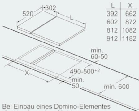
Bei Einbau eines Domino-Elementes direkt neben einer Mulde ist ein Montagesatz (HZ394301) erforderlich.
