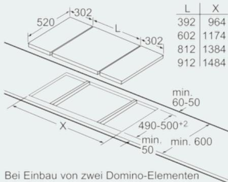
Bei Einbau von zwei Domino-Elementen direkt neben einer Mulde sind zwei Montagesätze (HZ394301) erforderlich.
