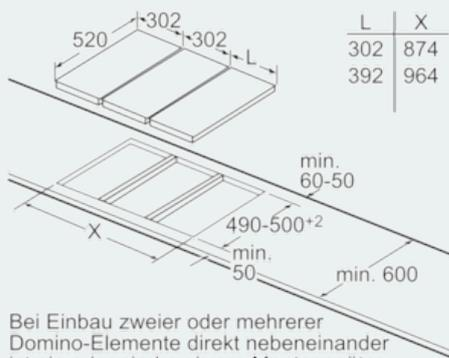
Bei Einbau zweier oder mehrerer Domino-Elemente direkt nebeneinander ist ein oder sind mehrere Montagesätze erforderlich (2 Elemente 1 Montagesatz, 3 Elemente 2 Montagesätze usw).
