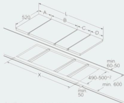
Bei Einbau zweier oder mehrerer Elemente nebeneinander ist ein oder sind mehrere Montagesätze erforderlich (2 Elemente 1 Montagesatz, 3 Elemente 2 Montagesätze usw).
