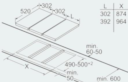
Bei Einbau zweier oder mehrerer Domino-Elemente direkt nebeneinander ist ein oder sind mehrere Montagesätze erforderlich (2 Elemente 1 Montagesatz, 3 Elemente 2 Montagesätze usw).
