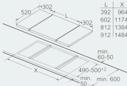
Bei Einbau von zwei Domino-Elementen direkt neben einer Mulde sind zwei Montagesätze (HZ394301) erforderlich.
