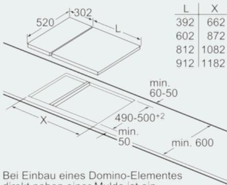
Bei Einbau eines Domino-Elementes direkt neben einer Mulde ist ein Montagesatz (HZ394301) erforderlich.
