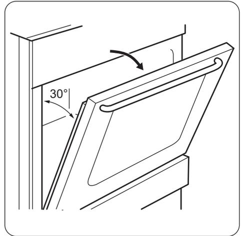
2. Fassen Sie die Türabdeckung (B) an der Oberkante der Tür an beiden Seiten an. Drücken Sie sie nach innen, um den Schnappverschluss zu lösen.
