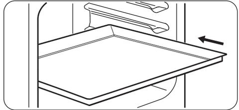
Setzen Sie das Backblech oder tiefe Blech in die Einschubebene ein. Achten Sie darauf, dass es nicht die Rückwand des Backofens berührt.
