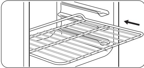
Setzen Sie den Rost in die richtige Einschubebene ein. Achten Sie darauf, dass er nicht die Rückwand des Backofens berührt.
