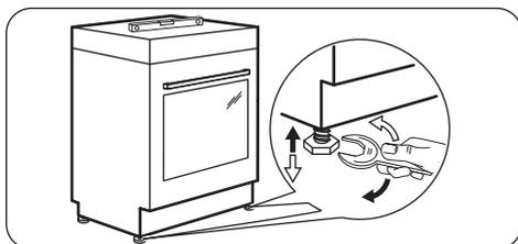
Richten Sie das Gerät mit den unten angebrachten Schraubfüßen so aus, dass sich die Oberfläche des Geräts auf einer Ebene mit den angrenzenden Oberflächen befindet.
