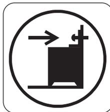
1. Bringen Sie den Kippschutz in einem Abstand von 317 bis 322 mm zur Geräteoberfläche und einem Abstand von 80 bis 85 mm zur Geräteseite in der runden Öffnung am Befestigungsteil an. Verschrauben Sie ihn in festem Material oder benutzen Sie eine geeignete Verstärkung (Wand).
