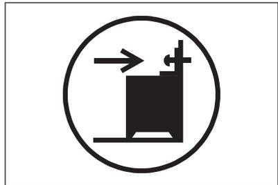
1. Bringen Sie den Kippschutz in einem Abstand von 317 bis 322 mm zur Geräteoberfläche und einem Abstand von 80 bis 85 mm zur Geräteseite in der runden Öffnung am Befestigungsteil an. Verschrauben Sie ihn in festem Material oder benutzen Sie eine geeignete Verstärkung (Wand).
