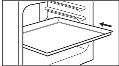
Setzen Sie das Backblech oder tiefe Blech in die Einschubebene ein. Achten Sie darauf, dass es nicht die Rückwand des Backofens berührt.
