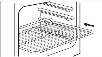
Setzen Sie den Rost in die richtige Einschubebene ein. Achten Sie darauf, dass er nicht die Rückwand des Backofens berührt.
