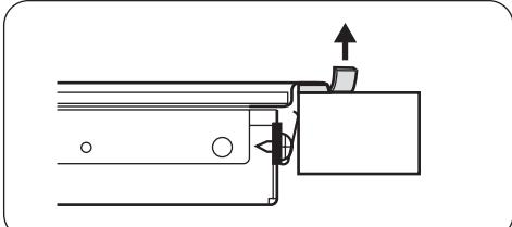
Placez la table de cuisson dans la découpe et poussez-la jusqu'à ce qu'elle soit en contact avec le plan de travail, puis enlevez le surplus de joint d'étanchéité.
