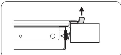
Setzen Sie das Kochfeld in die Aussparung und drücken Sie es nach unten, bis es die Arbeitsplatte berührt. Entfernen Sie dann die überschüssige Dichtung.
