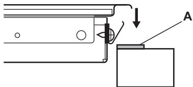
Collocare la guarnizione di tenuta A tutt'intorno al bordo dell'incasso.
