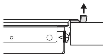
Montare il piano di cottura nell'incasso e spingerlo in basso finché non viene a contatto con la superficie superiore della cucina, quindi rimuovere la guarnizione in eccesso.
