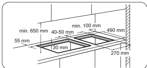
Verwenden Sie den Montage-Bausatz, der einen seitlichen Stützträger und zusätzliche Dichtungen enthält, wenn mehrere 30-cm-Kochfelder nebeneinander in dieselbe Aussparung eingebaut werden. Der Bausatz ist beim autorisierten Kundendienst erhältlich. Die Montageanleitung wird mit dem Bausatz geliefert.
