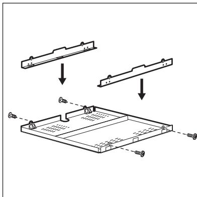
Falls Sie einen Schutzboden (optionales Zubehör) verwenden, ist die Schutzmatté direkt unter dem Gerät nicht nötig. Der Schutzboden ist möglicherweise in einigen Ländern nicht erhältlich. Wenden Sie sich an Ihren Händler vor Ort.
