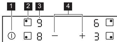
Bedienen Sie das Gerät über die Sensorfelder. Die Anzeigen, Kontrolllampen und akustischen Signale informieren Sie über die aktiven Funktionen.
