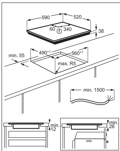
Als u een beveiligingsdoos (een additioneel toebehoren) gebruikt, is de beschermingsvloer onder het fornuis niet noodzakelijk. De beveiligingsdoos is als toebehoren niet in elk land verkrijgbaar. Neem contact op met uw plaatselijke leverancier.
